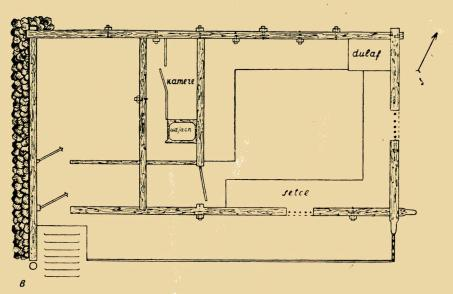
Рис. 11. Постройка из плах: a) план, b) деталь схема крыши, b) деталь скрепления плоских бревен. (Дом Бекир-Умерова, Бахчисарайский район, дер. Юкары-Каралез.)
