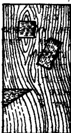
Рис. 18. Закладання сірниць та сучків. а—правильно; б—неправильно.
