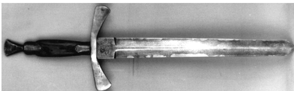
Рис. 12. Меч із булатної сталі з кількістю вуглецю 1,05%, виготовлений на заводі «Більшовик» (м. Київ) із витисненими карбідами заліза на лезо (білі плями)
