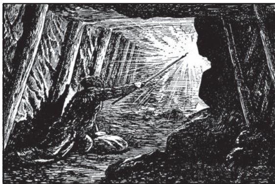
Випалювання газу біля покрівлі виробки
